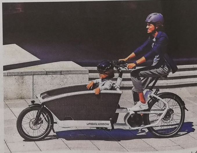
Länge läuft: Das Urban Arrow Family erstreckt sich über 2,60 Meter. Durch das kleine Vorderrad bleibt viel Platz für die Transportkiste. FOTO: URBAN ARROW
